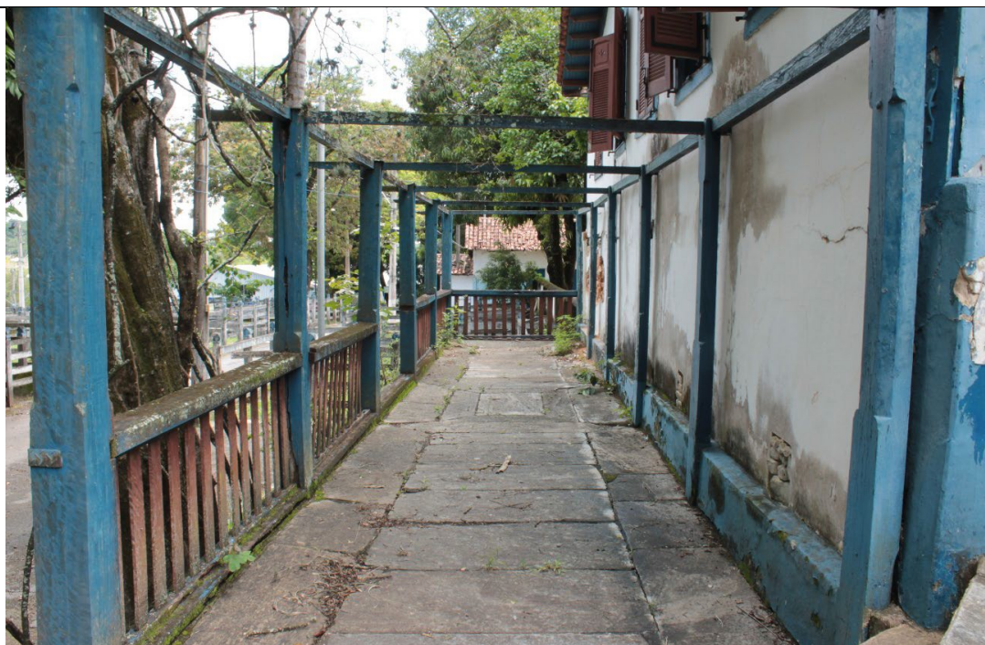
Figura 152. Caramanchão com piso de pedra quartzito lajão e estrutura de madeira maciça pintada de azul. Guarda corpo de madeira maciça pintada de azul e vermelho. Localizado do lado oeste da casa sede - Fazenda Boa Esperança. Foto: Brenda Souza, 17/02/2022.
